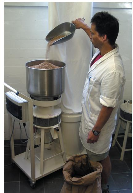
**Abb. 2:** Zentrofan-Vermahlungssystem [Quelle: BFEL, Detmold]
