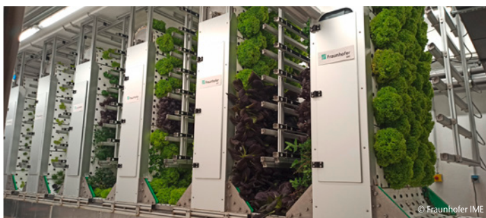
Abb. 3: Förderbandbasierte OrbiPlant®-Anlage zur Anzucht von Pflanzen. Die Anlage ist hier mit diversen Salaten und Kräutern bestückt.
