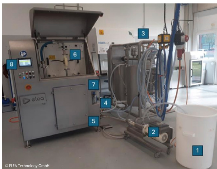
Abb. 6: Versuchsaufbau mit der PEF-Anlage PEFPilot™ Dual
