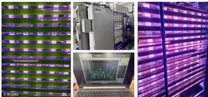
Abb. 4: Aufbau und Betrieb des 200-L-Forschungsmoduls (PACT200, PUEVIT GmbH, Dresden) des Innovationsraums NewFoodSystems Integration wassergekühlter LED-Leuchten sowie Datenaufnahme aus dem Prozess
