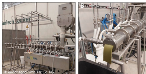
Abb. 7: Versuchsaufbau zur Nassextrusion einer Basisrezeptur aus Erbsenproteinisolat und PEF-behandelter Spirulina -Biomasse im technischen Maßstab (A), Extrudat aus Basisrezeptur unter Nutzung frischer Spirulina -Biomasse (B)
