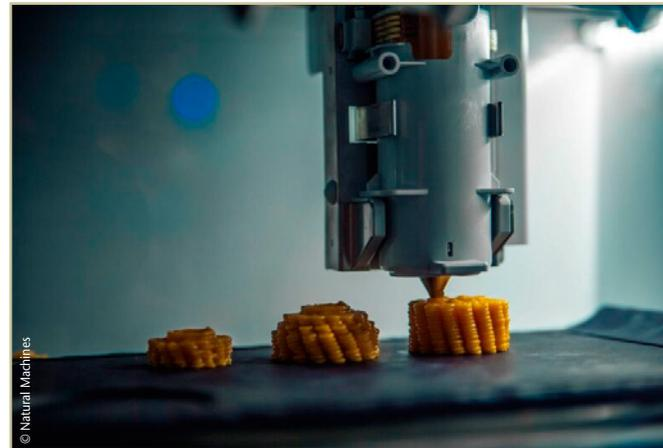
Abb. 1: b) Extrusionsbasierter Drucker beim Drucken einer „Maiskolben“-scheibe
